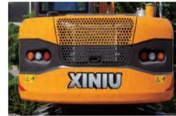
並列式冷却器、フルスチール・メッシュを使用したバックドアは風通しをよくし、冷却の効率化を実現しました。バックライトを全てカウンターウエイトの中に隠すことにより、仕事上の衝突を防ぎます。
